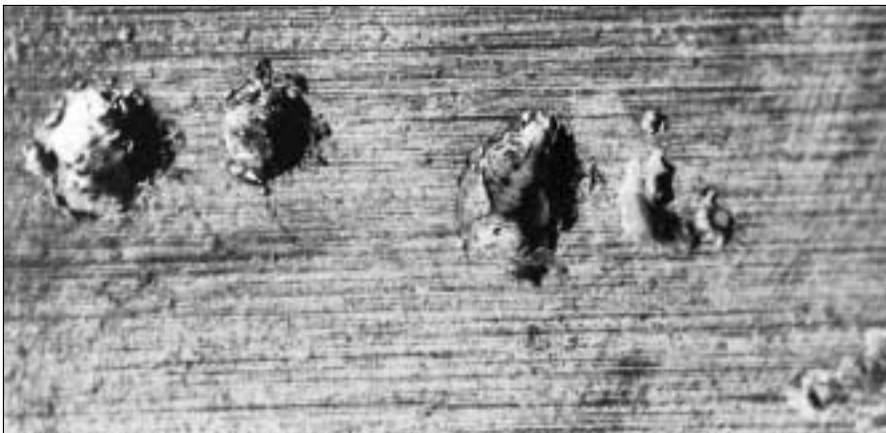
59: Las descargas eléctricas han dado lugar a la formación de cráteres en el camino de rodadura de un rodamiento de rodillos cilíndricos.
