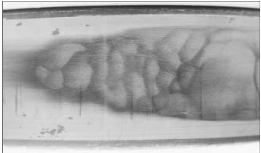
75: Daños por deslizamiento en el aro interior de un rodamiento de rodillos cilíndricos
