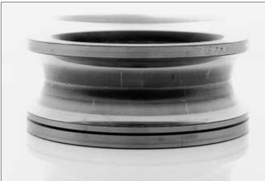
28: Huella de rodadura con desgaste superficial
