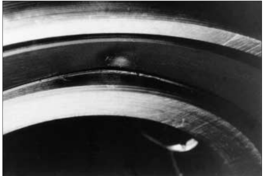
98: Obturación abollada con arañazos
