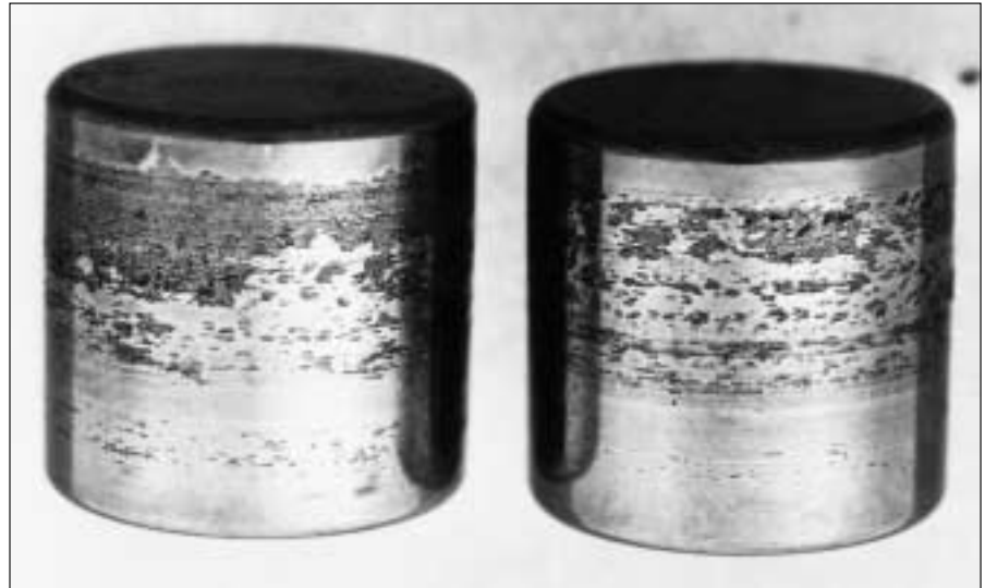
74: Huellas de deslizamiento en rodillos cilíndricos
