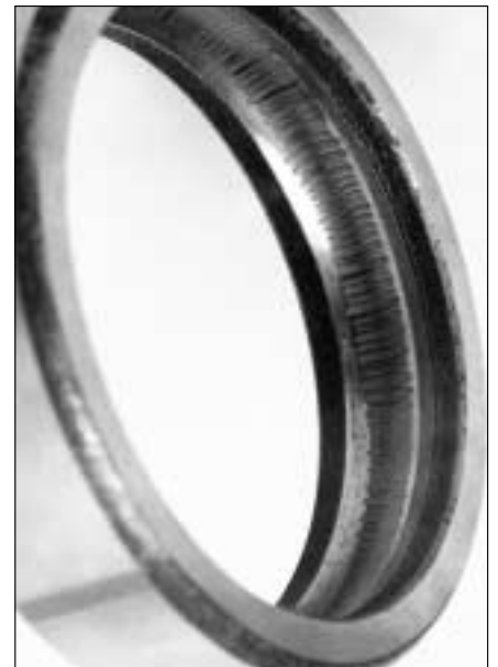
59: Las descargas eléctricas han dado lugar a la formación de cráteres en el camino de rodadura de un rodamiento de rodillos cilíndricos.
