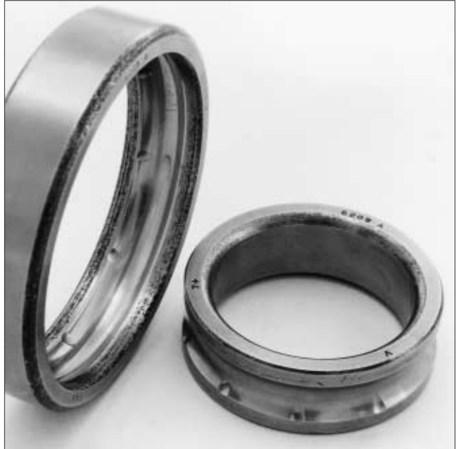
58: Indentaciones producidas por las bolas en los bordes de un rodamiento rígido de bolas. La herramienta de montaje ha sido aplicada en el aro con ajuste deslizante, y por lo tanto, las fuerzas han sido conducidas a través de las bolas.
