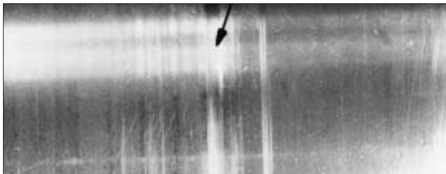
70: Profundas rayaduras aisladas en los rodillos a consecuencia de la retención de cuerpos extraños en la jaula
