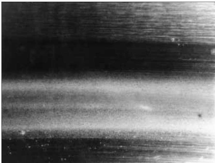
66: Camino de rodadura gastado, rugoso
