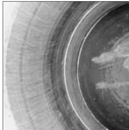
84: Formación de espigas en rodillos cónicos
