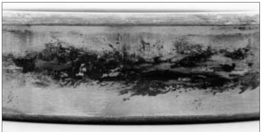
14: La oxidación en el ajuste hace visible el tamaño de la zona de carga en el aro exterior estacionario.
