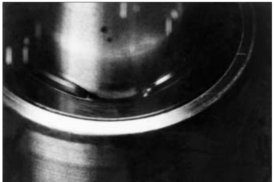
99: Labios obturadores girados del revés
