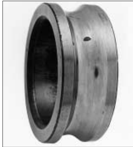
41: La fatiga clásica se pone de manifiesto en los hoyuelos (pitting) del camino de rodadura del aro interior de un rodamiento rígido de bolas. En la fase de deterioro avanzada se produce exfoliación de material en todo el camino de rodadura.
