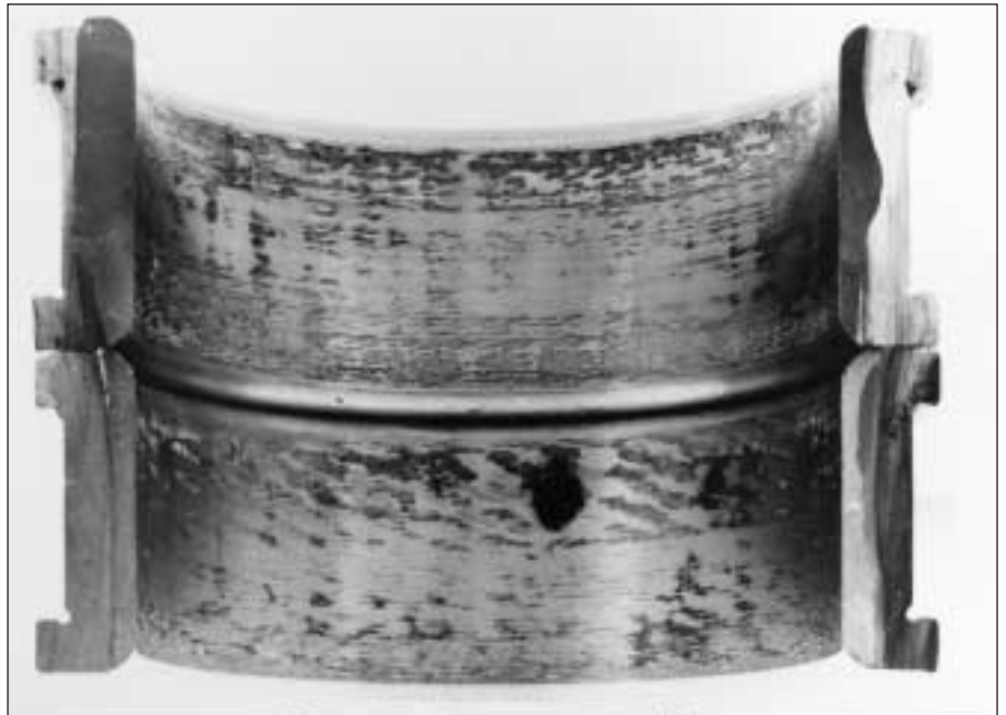
14: La oxidación en el ajuste hace visible el tamaño de la zona de carga en el aro exterior estacionario.
