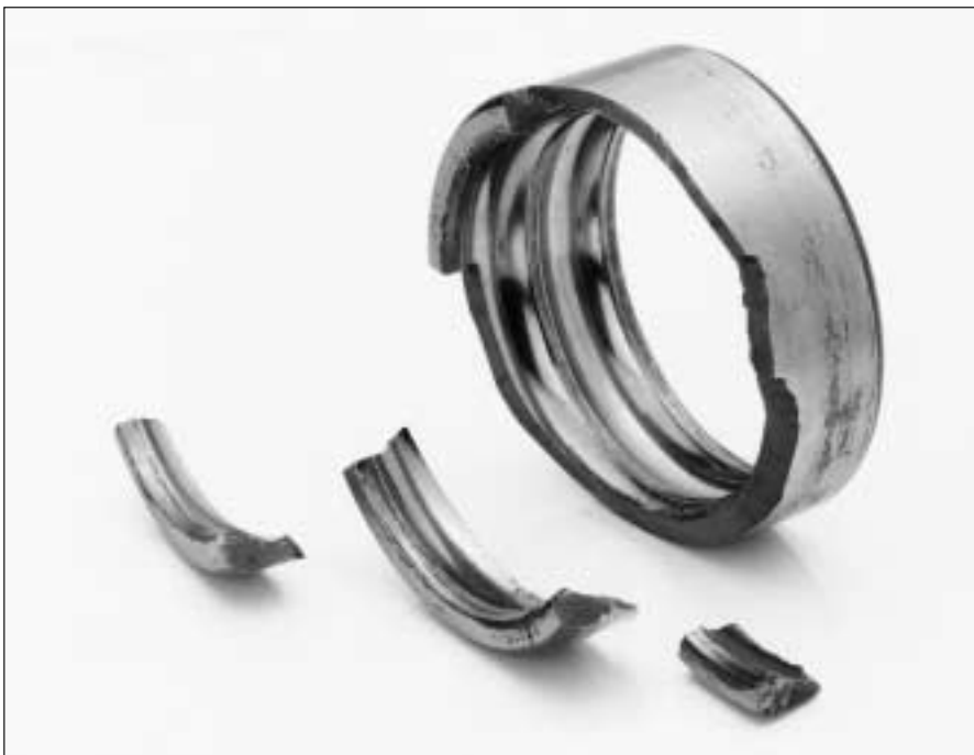
65: Rotura de un aro exterior en dirección circunferencial
